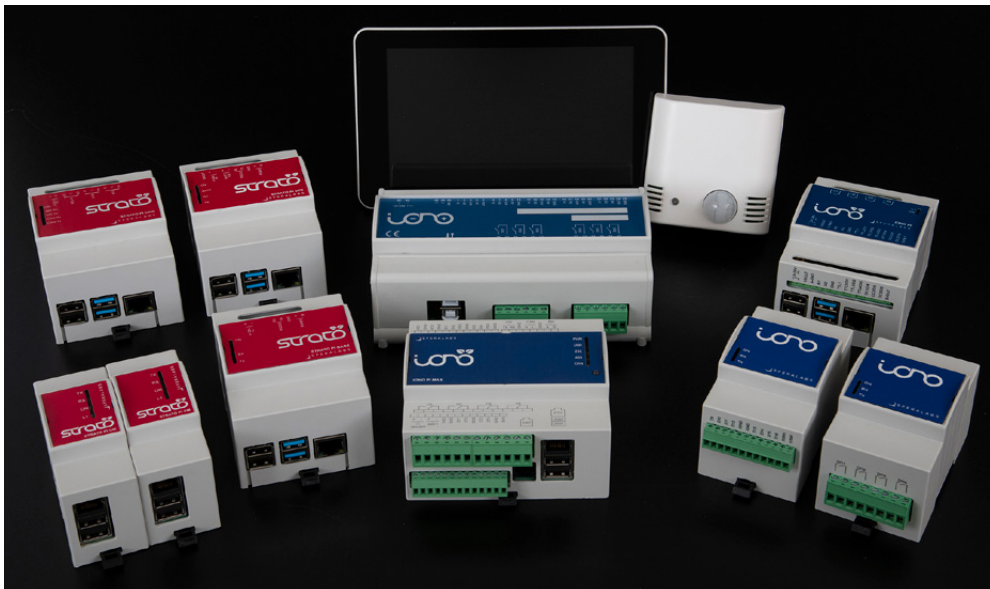
Figura 2 – Linea di Prodotti Sfera Labs: server industriali, moduli I/O (PLC) e sensori integrati basati su microcontrollori e SBC Raspberry Pi
